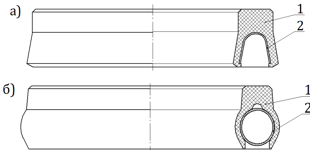
Рис. 1 Внешний вид манжеты: а – с пластинчатой пружиной,
